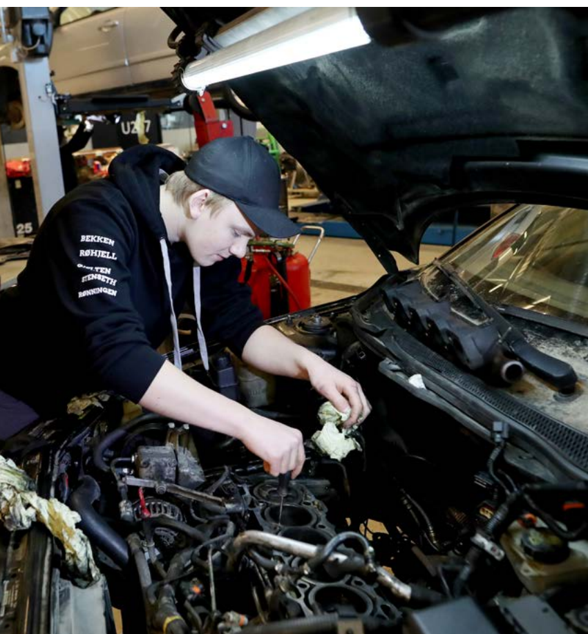
Markedsføringsansvarlig Markus Bekken skal skifte topplokk på denne motoren. Her renser han sylindrene.
