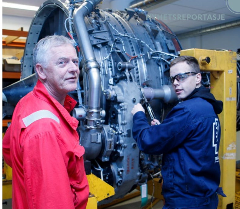
Odd Ivar Austegard (t.v.) er lærer i flytekniske fag. Her øver Morten Larsen Clausen på å låse bolter i flymotoren slik at de ikke løsner på grunn av vibrasjoner under flyging.
