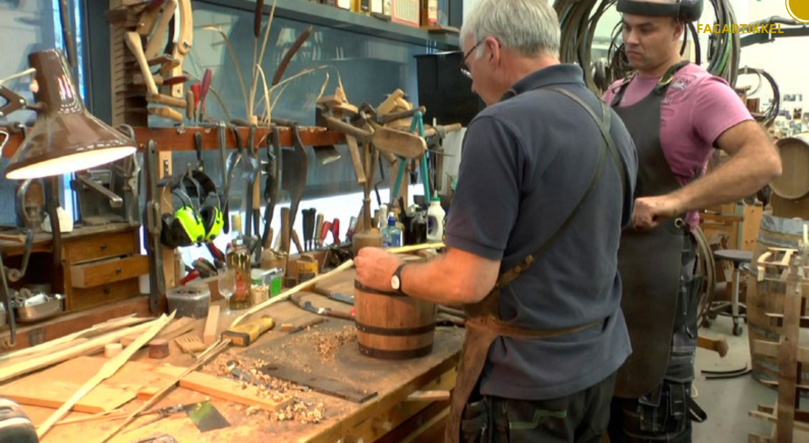
Bøkker Arne Jøran Øyen ved Anoras bøkkerverksted måler om fatet Gangstø lager, er rundt.
