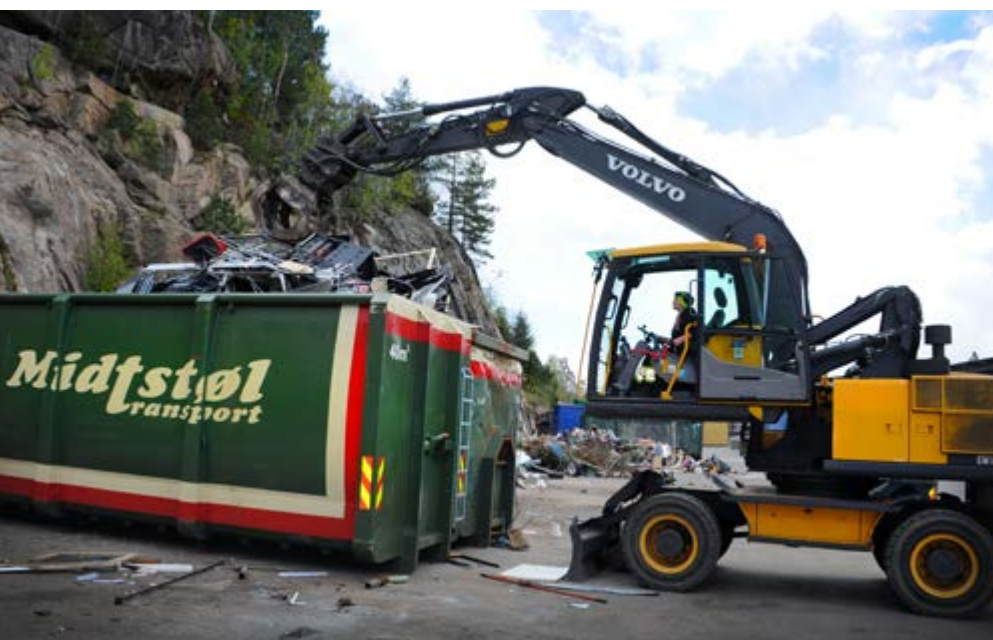
Her kjører hun en hjulgraver/sorteringsmaskin, Volvo 160 C, som det er 16-årsgrense på. Hun komprimerer avfall og gjør det klart til henting.
