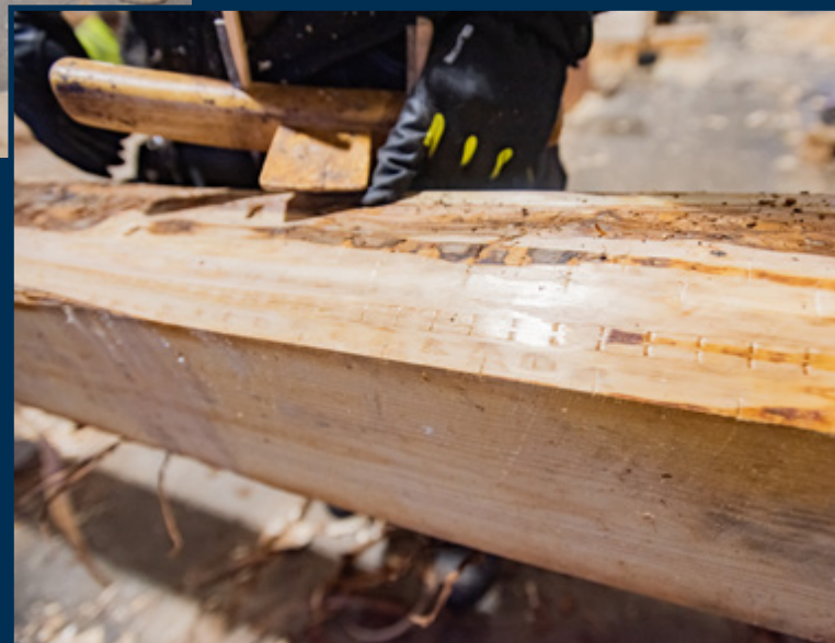
Et skavjern brukes for å gjøre tømmerstokken så jevn som mulig.
