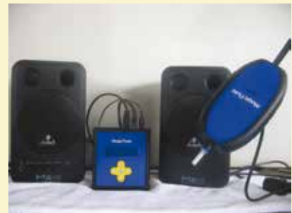
Trollfløyten består av selve fløyten, kontrollmodulen med innebygget lydkort, Midi-kabler og et bordstativ.
