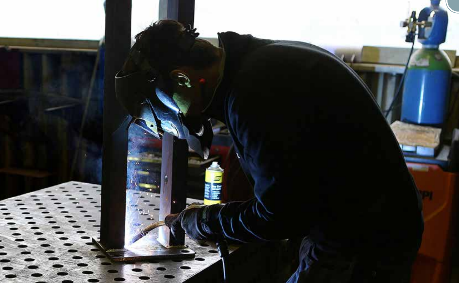
Vebjørn Vangskåsen sveiser en flaggstangfot.
